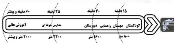
شکل ۲۱- دیاگرام تحلیلی مکان یابی فضاهای آموزشی بر اساس زمان و فاصله دسترسی
